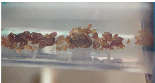
Рис. 2. Вид кристаллов НУП: 1 – кристаллы и маточный раствор, исходная доля \text{Pu}/(\text{Pu} + \text{U}) = 0.25 ; 2 – кристаллы по окончании сушки в эксикаторе, исходная доля \text{Pu}/(\text{Pu} + \text{U}) = 0.5 .
