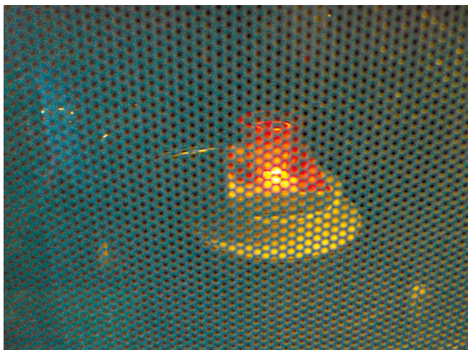
Рис. 1. Фотография кварцевого тигля, содержащего UN, при воздействии поля МВИ.
