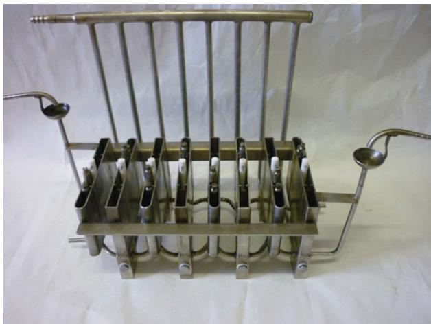
Рис. 4. Лабораторный экстракционный блок типа «смеситель—отстойник».
